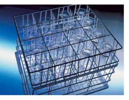
Die Gläser stehen leicht schräg im Korb, dadurch wird der Reinigungseffekt verstärkt und es bleibt nach dem Spülen kein Wasser in der Mulde des Glasfußes stehen. Für sehr hohe oder auch empfindliche Gläser gibt es Einteilungsaufsätze, die das Glas in einer stabilen Position halten. Diese Einteilungen gibt es praktisch für alle Glasformen und Größen.
